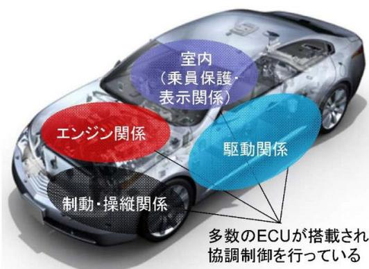
〔エンジン、トランスミッション、ブレーキなどに関連する装置にはECUが搭載され、近年の自動車には1台あたり数十個ものECUが搭載されているものもある。〕
